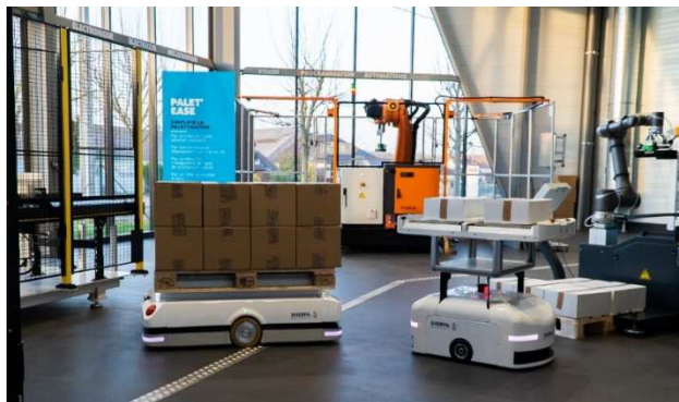
Sherpa-P (transport de palettes jusqu'à 1 tonne) – Sherpa-B (transport de bacs jusqu'à 200kg) exposés dans le Lab robotique ENGIE Solutions © agence Rove
